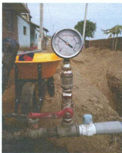
BOMBA DE AGUA MANUAL UTILIZADA EN PRUEBA HIDROSTATICA DE NUEVA MATRIZ, EX - PUNTE VENENO EN SECTOR PRIMAVERA
